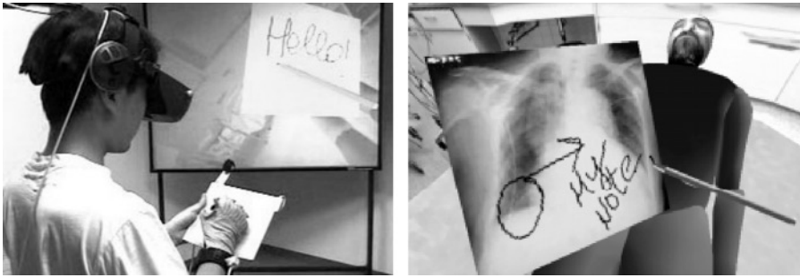
■ Abbildung 15 Ansicht des VR Notepads [15] aus der echten Welt und in VR. Der Nutzer kann auf einem Tablet mit einem Stift zeichnen. Gemalte Linien werden mit dem virtuellen Notizbuch synchronisiert.
