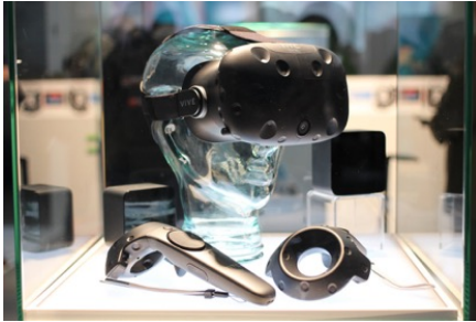
■ Abbildung 1 Diese Grafik zeigt die HTC Vive, die zwei Lighthouses und zwei Controller anbieter. Die Controller ermöglichen Interaktionen in der virtuellen Welt, während die Lighthouses Bewegungen des Nutzers in Echtzeit trackt.
