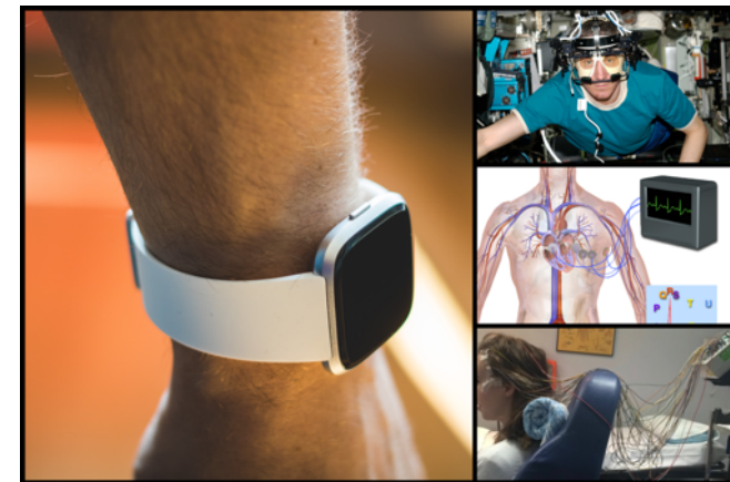
■ Abbildung 2 Verschiedene Arten der psychophysiologischen Messgeräte: Smartwatch [6], Eyetracking [3], EMG [2], EEG [1](von links im Uhrzeigersinn)
