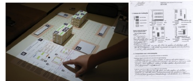
■ Abbildung 4 Umsetzung der Designprinzipien anhand der TinkerLamp. Links das Setup mit Projektion des Lagerraums und Miniaturregalen, rechts ein Tinkersheet, das als Aufgabenblatt dient [5]
