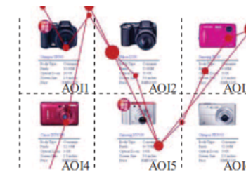
■ Abbildung 6 Prototyp von Cheng et al. [9] zur Erkennung von Nutzerpräferenzen für Digitalkameras. Dieser misst Fixationen (rote Punkte) auf Produkten. Bildnachweis: Cheng et al. [9].
