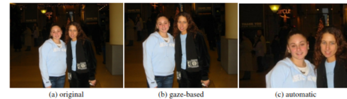
■ Abbildung 7 Beispiel von Eye-Tracking basiertem Zuschneiden von Bildern mit dem Algorithmus von Santella et al. [45]. Links zeigt das Originalbild, in der Mitte ist das recht gut zugeschnittene Bild per Blickbeobachtung. Rechts ist ein nicht so erfolgreich zugeschnittenes Bild zu sehen, das per visueller Prägnanzmethoden berechnet wurde, das hier Wichtiges mit Unwichtigem verwechselte.
