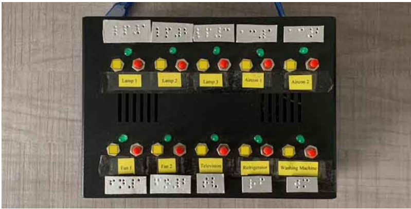
■ Abbildung 6 WiFi-basiertes Fernbedingungspanel mit Braille-Beschriftungen für elektrische Haushaltsgeräte [15].
