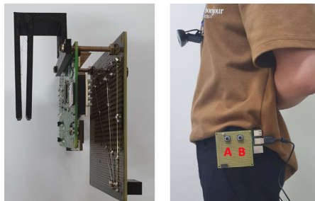
■ Abbildung 5 (a) zeigt eine gedruckte Halterung. (b) zeigt freihändige Geräte [10].
