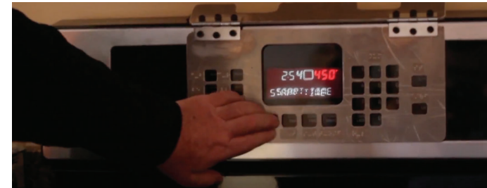
■ Abbildung 2 Ein Ofen Display, welches mittels Brailleschrift die visuellen Informationen zu haptischen Informationen konvertiert hat [11].
