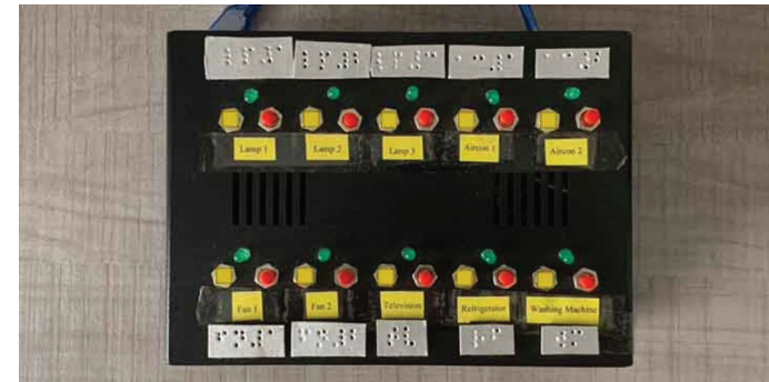
■ Abbildung 6 WiFi-basiertes Fernbedingungspanel mit Braille-Beschriftungen für elektrische Haushaltsgeräte [15].
