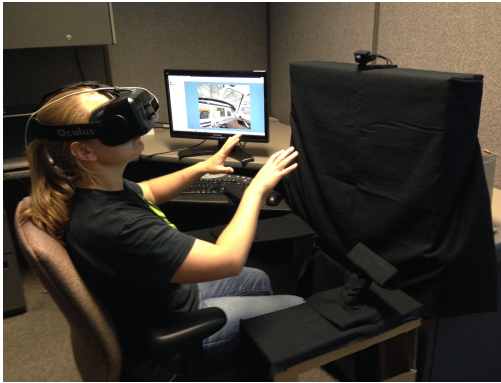
■ Abbildung 2 NutzerInnenstudie von MacAllister u.a. [16] in der die Testpersonen mittels Gesten, anhand von Leap Motion Bewegungsverfolgung, in der virtuellen Umgebung interagieren, welche über ein HMD (hier Oculus Rift) vermittelt wird.
