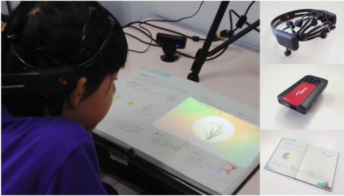
■ Abbildung 3 Bei sinkender Aufmerksamkeit des Kindes projiziert das System FOCUS eine Übung auf das Buch. Dadurch wird die Aufmerksamkeit zurückerlangt. (Abbildung: Huang et al. [6])
