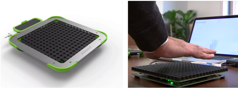
■ Abbildung 3 TOUCH Development Kit der Firma Ultrahaptics. Erwerbbarer Prototyp (links) und aufgebauter Prototyp mit Gestenerkennungssystem und Software in Verwendung (rechts) [19].
