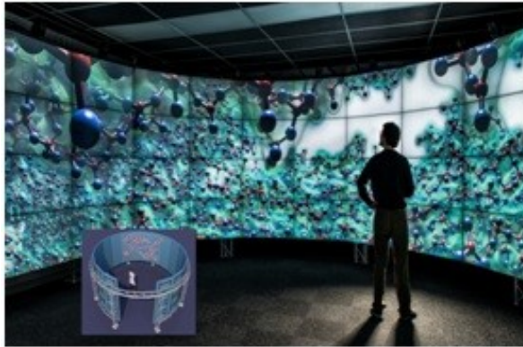
■ Abbildung 1 Beispiel eines CAVE-Systems. Die Person wird von Wänden umgeben, auf denen dreidimensionale Bilder projiziert werden [17].
