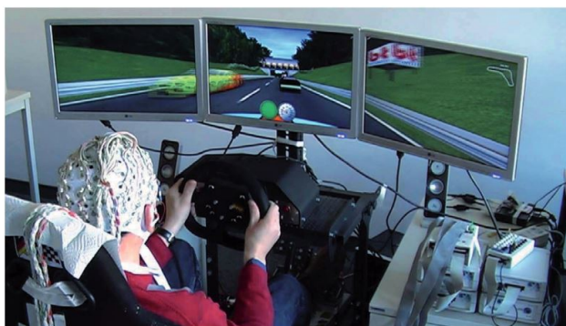
■ Abbildung 8 2D-Fahrsimulator mit angeschlossenem EEG um Gefahrenbremsungen einzuleiten [10].
